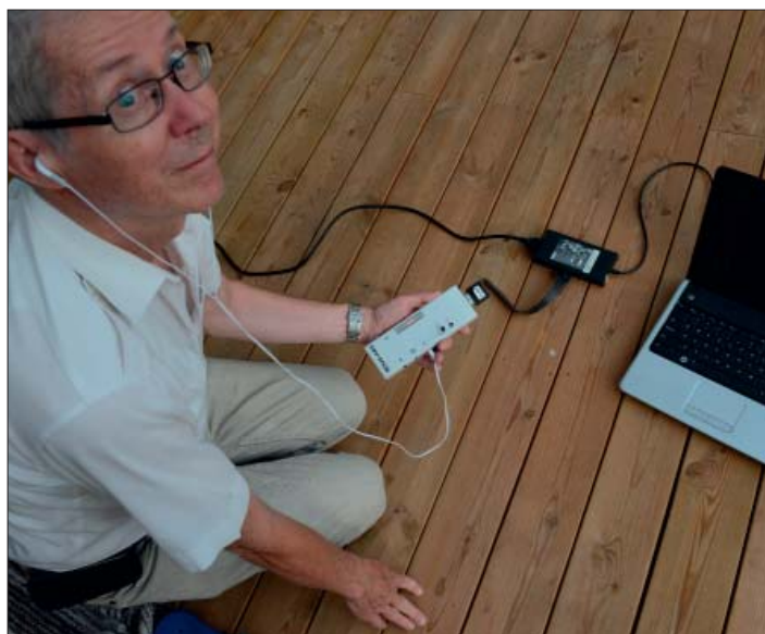
Bilden visar en felaktig laddare till en laptop. Den kunde detekteras på ett avstånd av 1,5 m.
